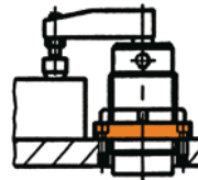
Con brida roscada y tuerca ranurada
